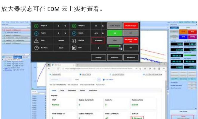
当测试开始或停止时，可使用 EDM VCS 控制器软件自动打开和关闭放大器。
